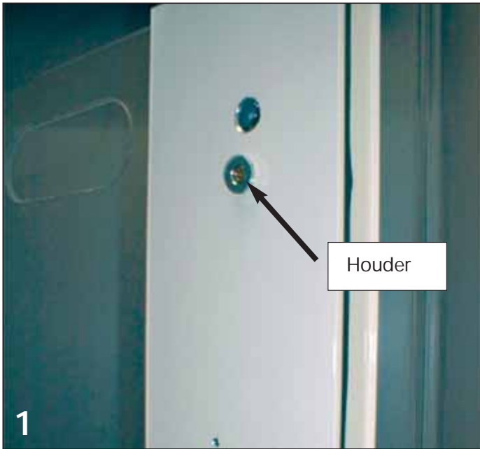
1 Bovenste houder op de buitenzijde van de deur vastschroeven.
