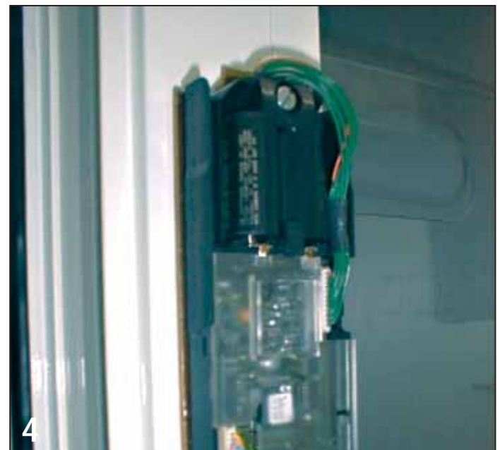
4 Batterij monteren en met klemstuk borgen.
