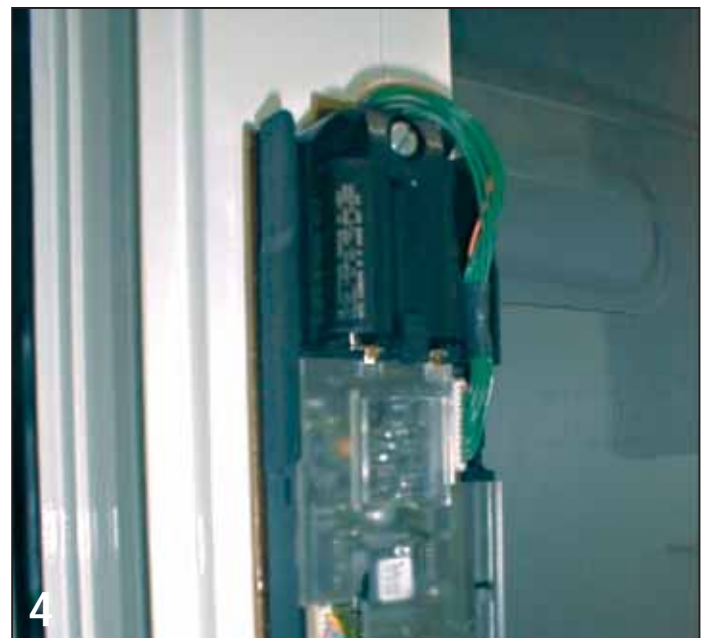
Batterie einbauen und mit Klemmstück sichern.
