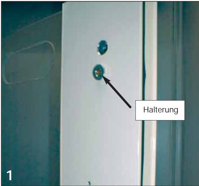
Obere Halterung auf Außenseite der Tür festschrauben.
