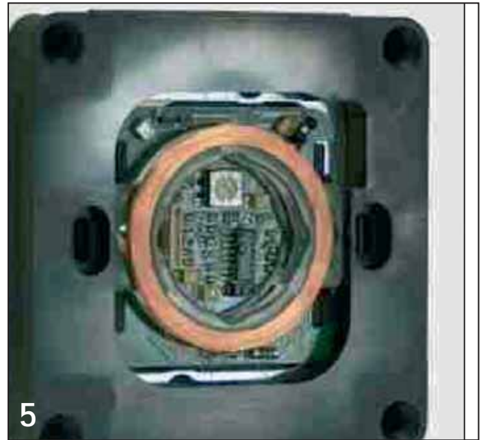
5 Kaartlezer op de inbouwdoos uitrichten en met de bij- gevoegde schroeven bevestigen. Schroeven voorzich- tig vastschroeven (printplaat mag niet vervormd wor- den). Alternatief met 4 schroeven aan de buitenste bevestigingspunten vastschroeven. Gebruik bij de ondergrond passende schroeven, ev. ook deuvets. Controleer of de adresschakelaar niet op positie "0" (uitgeschakeld) staat.
