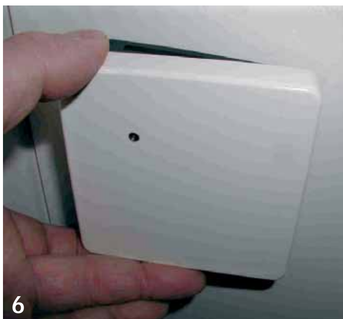
6 Enclencher le cache à encastrer ES5410 de sorte que la fenêtre transparente soit située en haut à gauche et que la lampe DEL soit visible à travers la fenêtre transparente.
