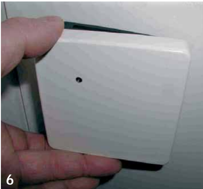
6 Die UP-Abdeckung ES5410 so aufrasten, dass das Klarsichtfenster oben links liegt und die LED durch das Klarsichtfenster sichtbar ist.
