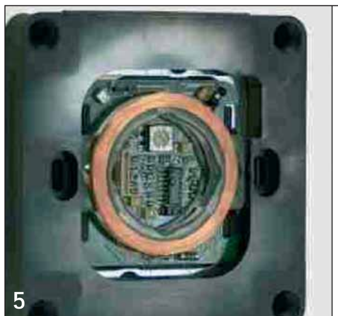
5 Orienter le lecteur mural du boîtier à encastrer et serrer à l'aide des vis jointes. Resserrer avec précaution les vis (la platine ne doit pas se déformer). De manière alternative, serrer les 4 vis sur les points de fixation extérieurs. Utilisez les vis adaptées au support, par ext. des chevilles. Contrôlez que le commutateur d'adressage n'est pas en position « 0 » (éteint).
