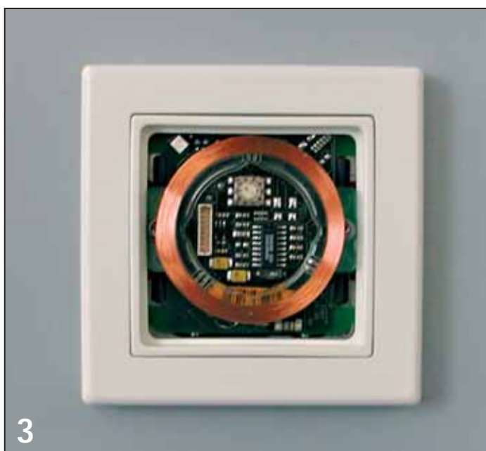
3 Installez le cadre de commutation, le cas échéant, avec un cadre d'utilisation supplémentaire sur le lecteur mural par ext. sur le module de lecture (ici: Cadre de la Sté. Merten)
